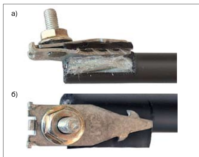
Рис. 3.4. Соединитель экрана 4460-D установленный на отогнутый в сторону кусок алюмополиэтиленовой оболочки с полимерным покрытием на внутренней стороне: а – вид сбоку; б – вид сверху.
