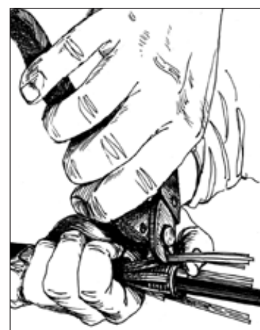
Рисунок 4.5 – Установка конуса (а) и обрезка проволок бронепокрова ОК (б)
