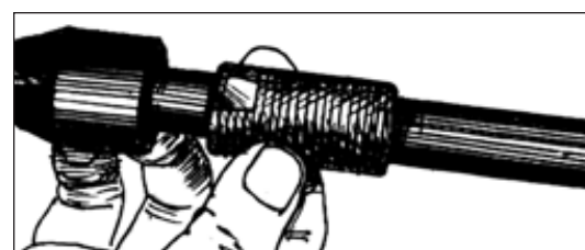
Рисунок 4.4 – Установка деталей узла ввода на ОК
