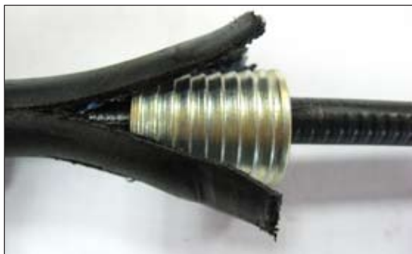
Рисунок 4.7 – Установка конуса на ОК со сталеполиэтиленовой оболочкой
