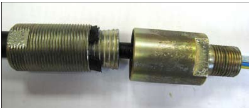
Рисунок 4.8 – Установка штуцера на втулку с наружной резьбой
