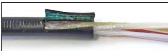
Рисунок 4.3 – Разрез оболочки ОК вместе со стальной гофрированной лентой
