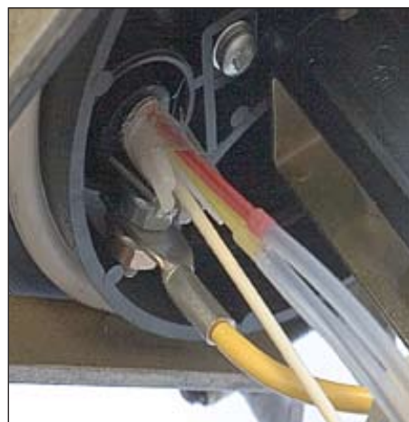
Рисунок 5.4 – Установленные на ОМ отрезки транспортных трубок (а) и их крепление на кассете с помощью скобы (б)
